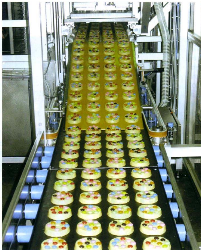
Cookie-Linie mit Topping-System zur Verarbeitung von pastösen Massen wie zum Beispiel Mürbeteig
